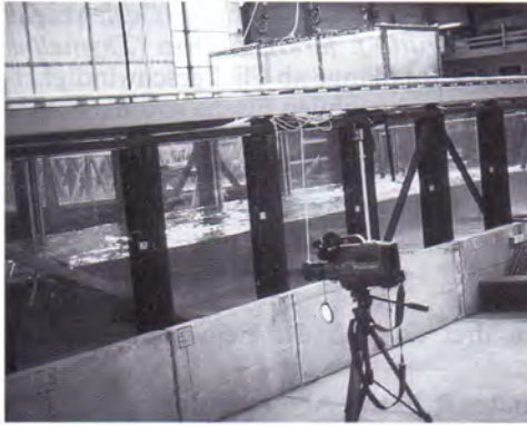
Abb. 1: Ausschnitt aus dem Modellgerinne der TH Darmstadt – der Startkäfig hängt am Hallenkran
