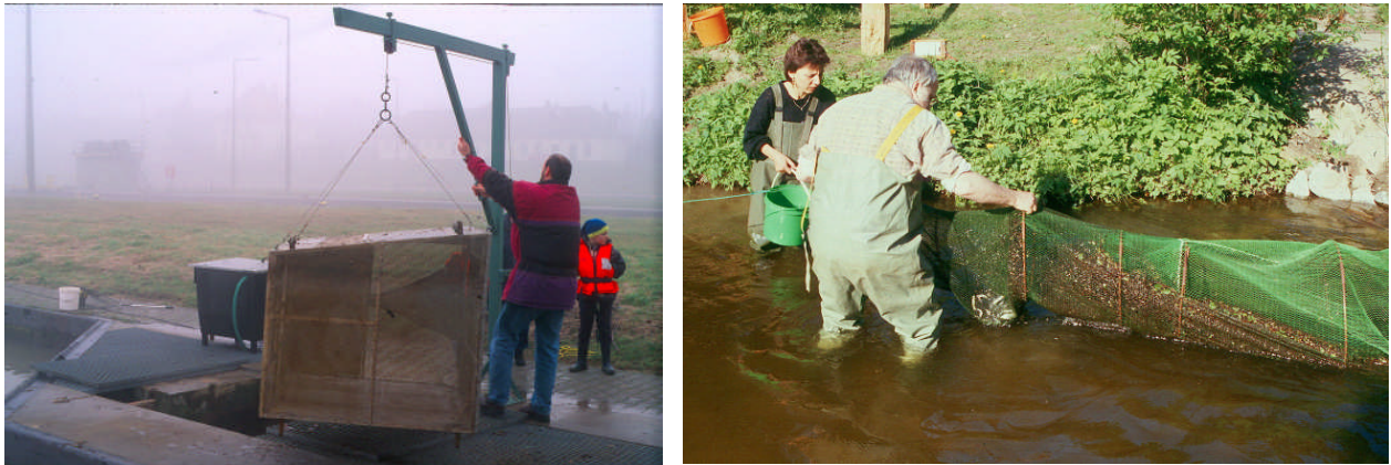
Bild 4: a) Kasten- und b) Netzreuse im Einsatz bei Funktionskontrollen
